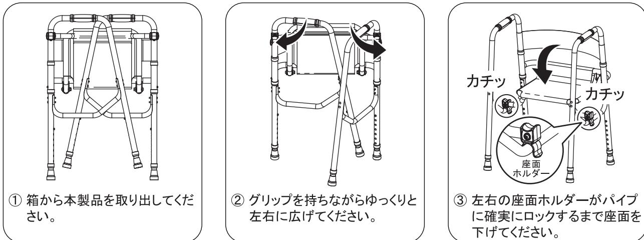
△警告 左右の座面ホルダーが確実にロックされているか、グリップを内側に動かして確認してください。
